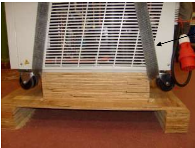
Seitenansicht der Gurtverlegung
